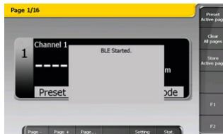
Schließen Sie den Bluetooth-Empfänger an einen USB-Anschluss der D300S an und schalten Sie die Einheit ein. Die Verbindung wird automatisch aktiviert und folgende Meldung erscheint beim Einschalten an der Einheit.
