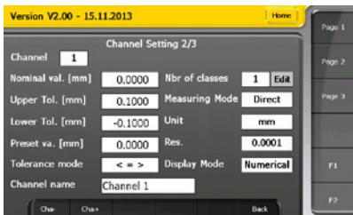
Configuration des paramètres de mesures d'un canal, tels que les tolérances ou la valeur de preset.
