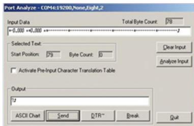
Taper dans la fenêtre « output » la rétro-commande « ? » suivi du caractère « CR » carriage return ASCII (13) pour afficher la valeur des canaux actifs.
