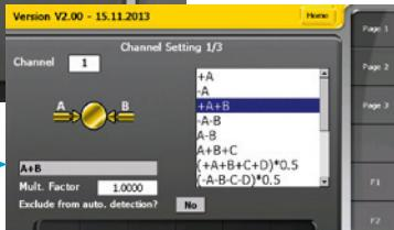
Weisen Sie die Instrumente zu, die bei der Berechnung berücksichtigt werden sollen. Wählen Sie das Instrument für Kanal A, danach für Kanal B.
