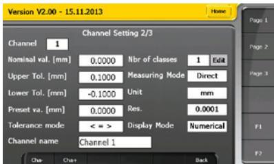
Konfiguration der Messeinstellungen des Kanals, wie Toleranzen oder Preset-Wert.
