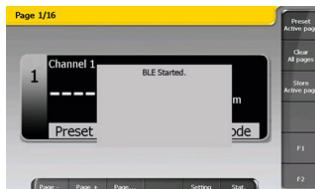
Connecter le récepteur Bluetooth sur un port USB de la D300S puis enclencher l'unité. La connexion s'active automatiquement et le message suivant apparaît au démarrage de l'unité.
