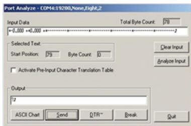
Geben Sie im Feld „Output“ den Steuerbefehl „?“ und die Buchstaben „CR“ carriage return ASCII (13) ein, um den Wert der aktiven Kanäle anzuzeigen.
