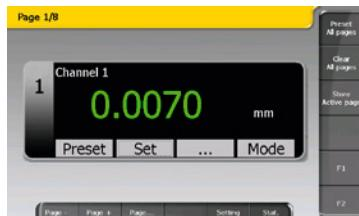
Nun ist Kanal 1 so konfiguriert, dass er den Wert A+B der beiden gewählten Instrumente anzeigt und die Farbe des Wertes den Zustand der Messung angibt (entsprechend den eingegebenen Toleranzwerten).
